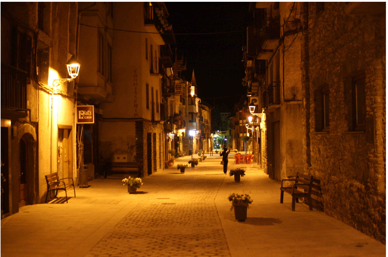
Bild 6: Voll abgeschirmte Leuchten erhellen die Verkehrsfläche und leuchten kaum auf die Hausfassaden und in die Fenster.
