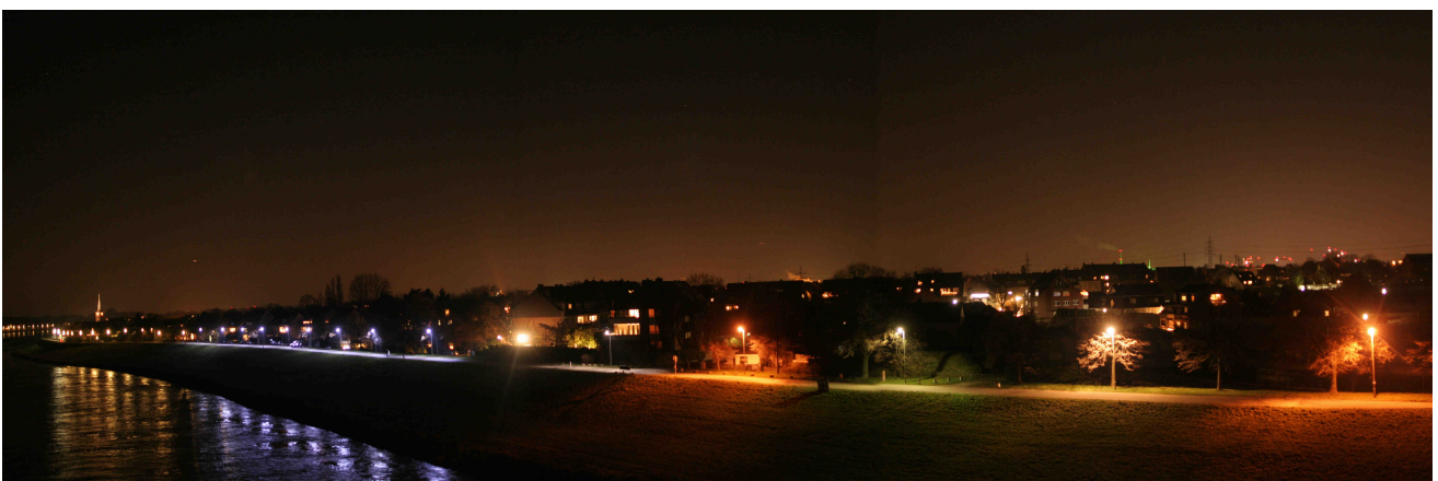
Bild 8: Fußwegbeleuchtung mit Lichtquellen unterschiedlicher Farben in Düsseldorf (ganz links Gasleuchten, blau: kaltweiße LED, warmweiße LED, gelb: Natriumhochdruckdampfampe, grün: Quecksilberdampfampe; hellgelb: Halogenmetaldampfampe)
